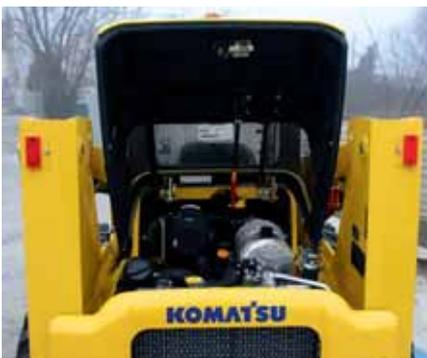
Capot: contrôle rapide des éléments du moteur
