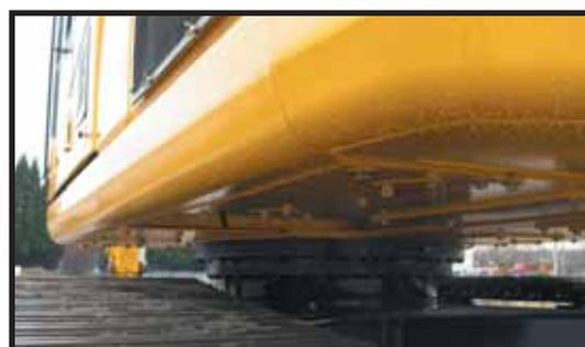
Des tôles épaisses sont fixées sous la tourelle, offrent une protection accrue contre les débris au sol.
