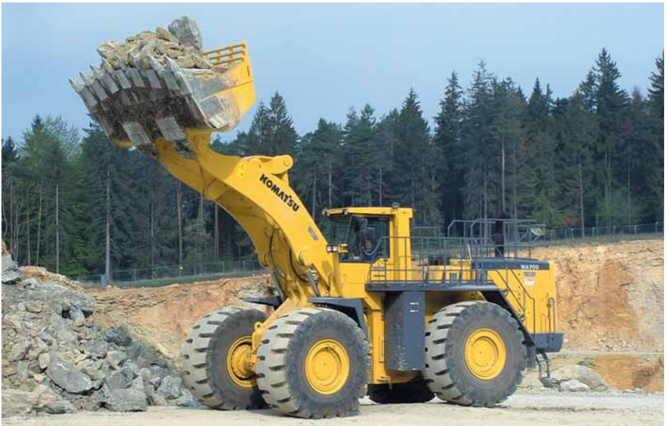
WA700-3 Haute élévation en action
