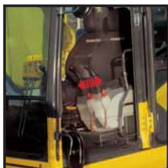
Plage de glissement du siège: 340 mm
