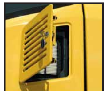
Filtre à air intérieur Installation / enlèvement aisé du filtre de la climatisation, sans outils, pour un nettoyage plus aisé.
