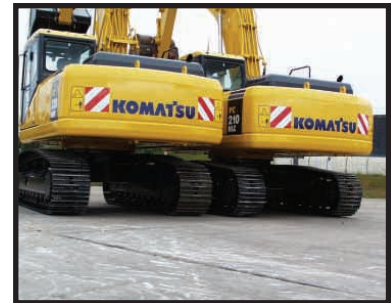
La tourelle de la PC230NHD-7 est 25mm plus haute que celle de la PC210NLC-7
