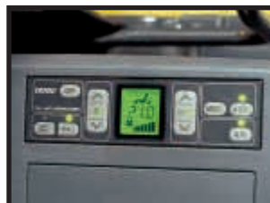
Climatisation à régulation de température
