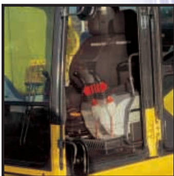
Plage de glissement du siège : 340 mm
