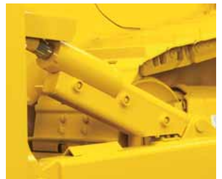
Dans la mesure du possible, les conduites hydrauliques sont intégrées dans les structures
