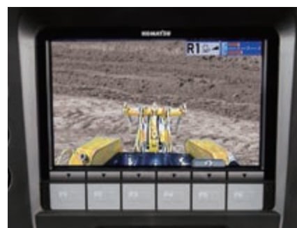
Système de caméra vue arrière complètement intégré
