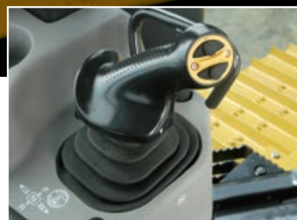
Système ergonomique PCCS (Palm Command Control System)
