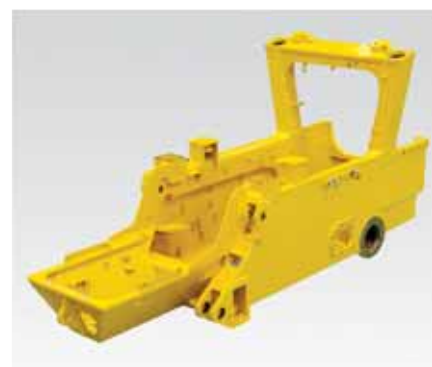
Structure du châssis à simple coque haute rigidité
