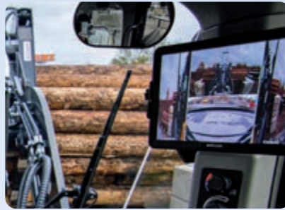
Kamerasystem für optimale Sicht bei großen Anbaugeräten
